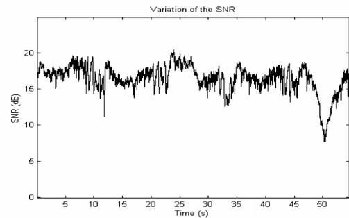
Figure 8 : R.S.B. obtenu à la sortie de l'égaliseur
