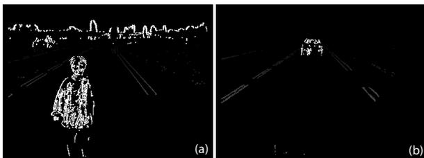
FIG. 5 – Exemples de cartes de disparité de l'environnement du véhicule (a) par beau temps, (b) par temps de brouillard. Les points blancs sont considérés comme des obstacles. Le niveau de gris des autres points est proportionnel à leur disparité et par là-même à leur profondeur.
