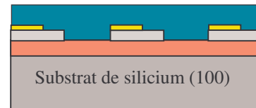
4- Dépôt de 1000Å de nitrure PECVD et gravure RIE des plots de contacts
