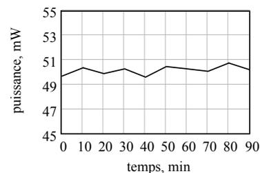
Figure 2 : Instabilité de puissance de générateur.
