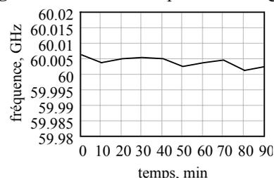
Figure 3 : Instabilité de fréquence de générateur.
