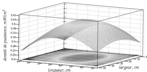
Figure 4 : Distribution de puissance sur la membrane.
