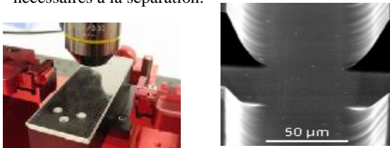
Figure 7 : A gauche : vue large champ d'un LOC. A droite : photo MBE des canaux microfluidiques.
