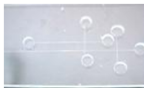
Figure 9 : Laboratoire sur puce possédant 2 canaux de séparation en parallèle. Longueur du canal court :5cm ; longueur du canal long :7cm.
