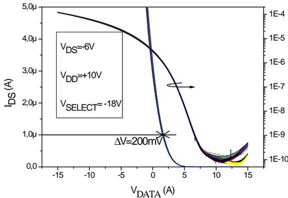
FIG. 5 – Caractéristiques de transfert de 15 TFT microcristallin de commande situés sur des pixels voisins.
