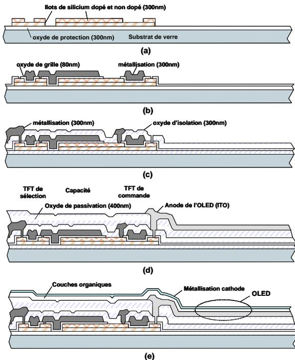
FIG. 3 – Principales étapes du procédé de fabrication de circuit pixel OLED en TFT microcristallin. (a) Dépôt et définition des couches  $\mu\text{c-Si}$ . (b) Dépôt de l'oxyde de grille et du premier métal. (c) Oxyde d'isolation et second métal déposés. (d) Dépôt d'un oxyde de passivation puis anode définie. (e) Couches organiques puis cathode déposées.
