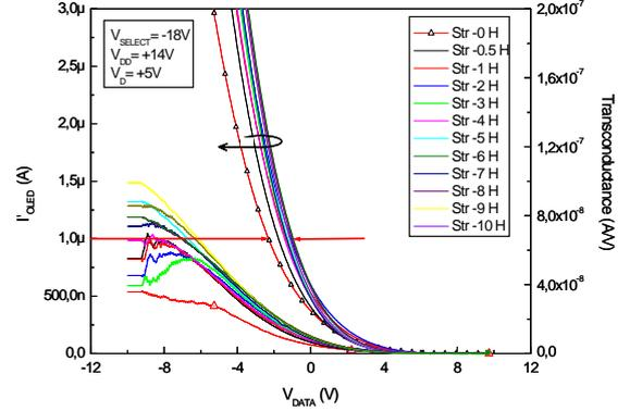
FIG. 15 – Représentation linéaire des caractéristiques de transfert d'un circuit pixel  $\mu\text{c-Si}$  pour différentes durées de stress électrique.
