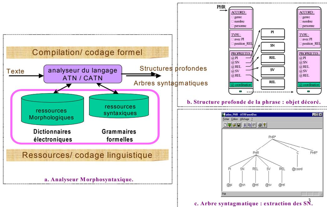
Figure 3.1. Architecture de l'analyseur morphosyntaxique : PARSE\_Fr.
