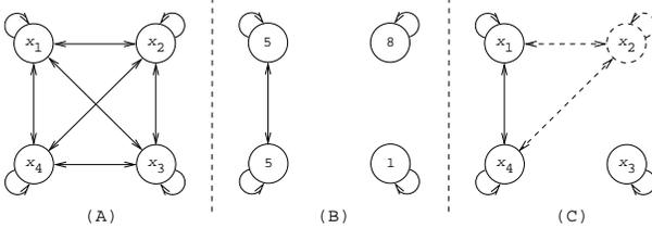
FIG. 1 – (A) Graphe initial  $G_i$  associé à la contrainte  $\text{nvalue}(N, \{x_1, x_2, x_3, x_4\})$ . (B) Graphe final  $G_f$  de la solution  $\text{nvalue}(3, \{5, 8, 1, 5\})$ . (C) Graphe intermédiaire.
