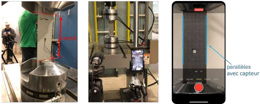
FIGURE 2 – De gauche à droite : échantillon centré dans la machine de traction ; caméras placés face à l'échantillon ; capteur du smartphone aligné sur le motif de grille de l'échantillon.
