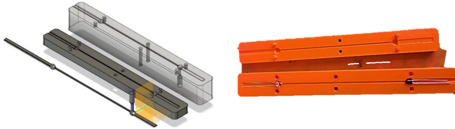
Figure 59: Le moule fermé pour l'injection à l'aide d'une seringue
