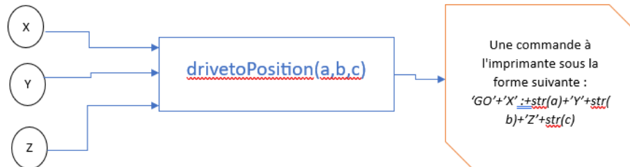
Figure 65: schéma représentant le fonction driveToPosition(a,b,c)
