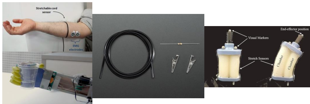
Figure 18: détection la contraction des muscles pour contrôler une main prothétique et un manipulateur à trois chambres pneumatiques avec le capteur basés sur les élastomères
