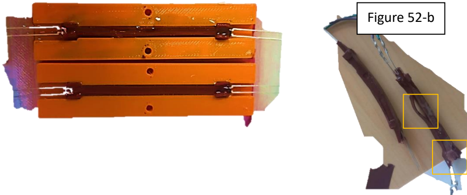
Figure 52: les capteurs avec le Vytaflex qui est versé directement dans les moules, les ruptures et les coupures obtenues
