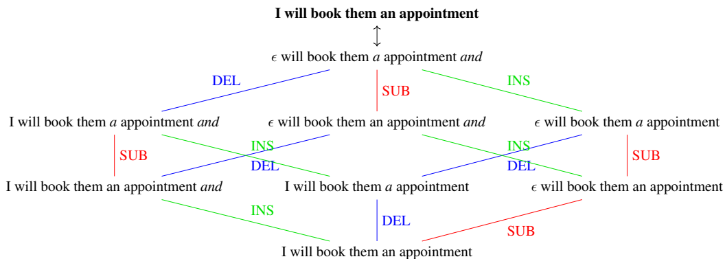
FIGURE 1 – Graphe de chaque modification possible pour obtenir une hypothèse sans erreur avec le paradigme minWED. Chaque arête correspond à une erreur corrigée. Étant donné la référence, nous avons trois erreurs de mots, chacune d'un type différent : 1 substitution, 1 insertion, 1 suppression. La métrique est basée sur la règle "le plus faible le meilleur". Le symbole \epsilon correspond à une suppression.
