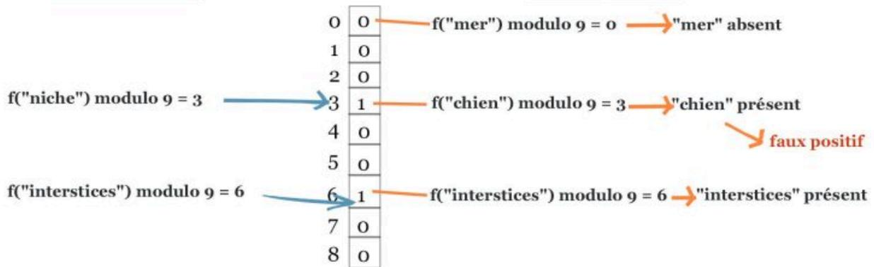
Exemple d'utilisation d'un filtre de Bloom pour indexer des mots. Un filtre ici composé de 9 bits, est initialisé avec les mots « niche » et « interstices ». Il est interrogé avec les mots « mer », « chien » et « interstices ».
