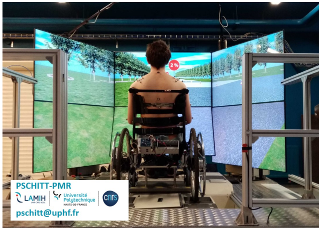
FIGURE 1. Sujet équipé installé dans le simulateur PSCHITT-PMR (écrans, bancs à rouleaux, FRM instrumenté).
