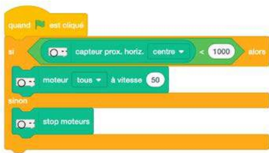
Ce script ne fonctionne pas car le test du capteur central n'est exécuté qu'une seule fois, au tout début de l'exécution du script. Une fois ce test effectué, l'exécution du programme se termine. Thymio est alors livré à lui-même et ne communique plus avec Scratch. S'il n'y a pas d'obstacle, ses moteurs se mettent en route, Thymio continue à avancer.
