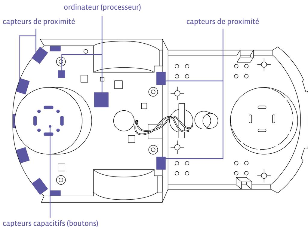
**Remarque:** les capteurs de distance sont aussi appelés capteurs de proximité.
