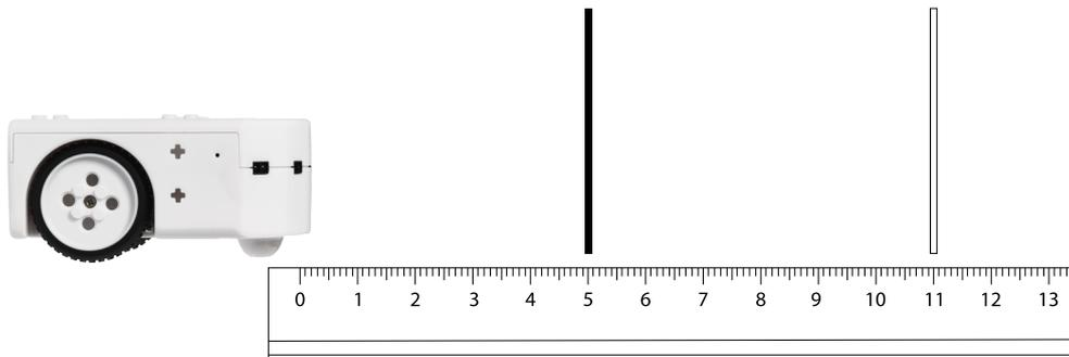
On conclut que les capteurs du robot Thymio ne captent pas de la même façon une feuille blanche et une feuille noire. Mais qu'en est-il si l'on utilise d'autres matériaux, d'autres matières, d'autres couleurs?
