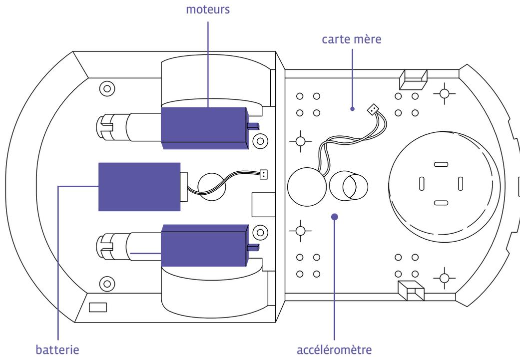
La batterie alimente les deux moteurs qui permettent de faire tourner les roues.
