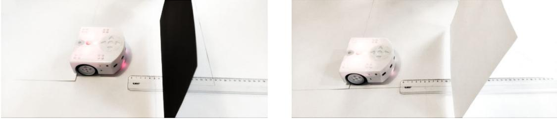
On voit ci-dessus le dispositif mis en place pour mesurer à partir de quand les capteurs captent. La règle permet de mettre en évidence que la feuille noire est beaucoup plus proche du capteur que la feuille blanche. C'est cette dernière qui est détectée en premier. On peut laisser le soin aux élèves de trouver comment visualiser les différences. On peut sinon leur proposer d'utiliser la règle, en l'incluant dans le matériel pour le groupe.
