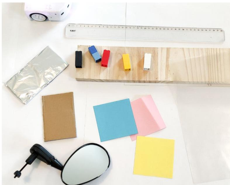
Les élèves utilisent le même dispositif que lors de l'étape précédente, à savoir la règle graduée posée devant le robot en mode violet pour mesurer à partir de quel moment les capteurs détectent l'objet placé devant le robot.
