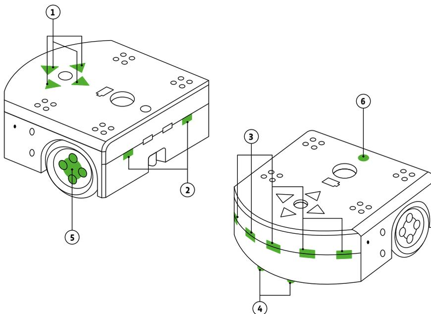
Pour allumer le robot, il suffit d'appuyer et de maintenir le doigt sur le rond qui se trouve au centre des flèches jusqu'à ce que le robot émette un son et devienne vert. Cela prend quelques secondes. Pour éteindre le robot, il suffit de maintenir le doigt sur le rond central quelques secondes jusqu'à ce que le robot joue une mélodie et s'éteigne complètement.
