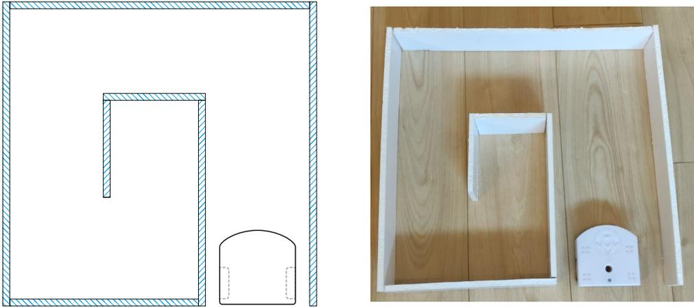
Il s'agit d'un carré (de 50 cm de côté minimum et 5 cm de haut minimum pour dépasser la hauteur de ses capteurs de proximité), à réaliser dans du carton épais (type carton plume). Le carton épais permet à la structure d'être plus stable. Les dimensions des différents murs sont les suivantes :
