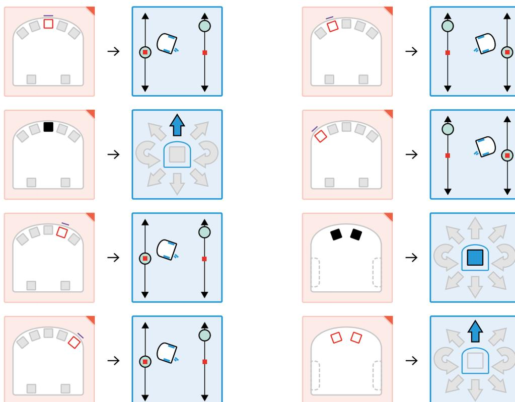
🔍 Une autre remarque apparaîtra peut-être: le robot Thymio ne s'arrête pas forcément quand il arrive devant une maison. Le souci vient du fait que les 2 capteurs du dessous ont été programmés ensemble:
