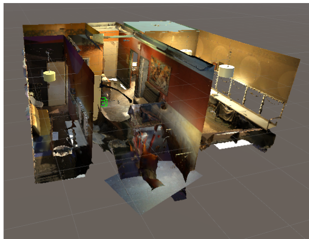
Figure 2. Reconstruction photogrammétrique des loges du théâtre du Monfort.
