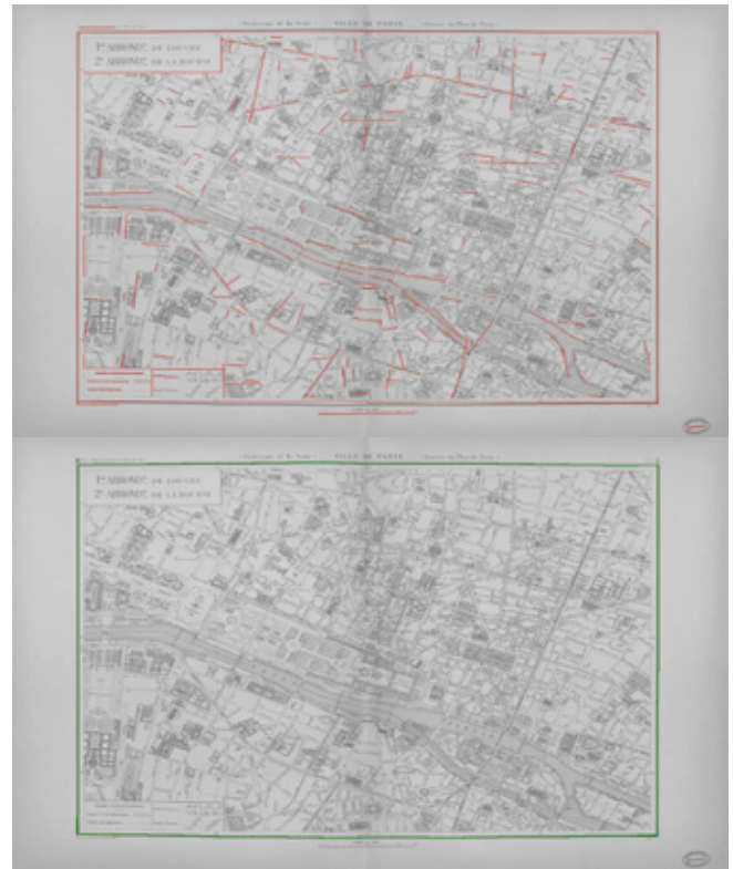
Figure 2. Étape 1 : détection des segments épais (ici 181 segments en rouge) et reconstruction du cadre extérieur en vert en sélectionnant les segments constituant un grand rectangle.
