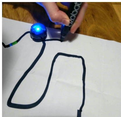
Figure 1 : Humain traçant une ligne devant le robot Ozobot pour lui offrir un nouveau chemin.
