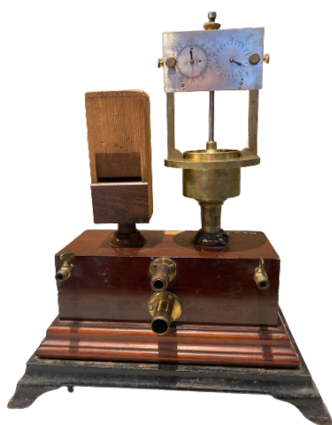
Figure 1. Gauche : la sirène de Cagniard (Coll. Scientifique de l'Université de Rennes 1). Droite : Simulation du fonctionnement de la sirène et réalité virtuelle.
