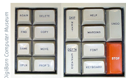
Clavier du Star avec pavés de touches de fonctions disposés de part et d'autre du clavier alphabétique.
