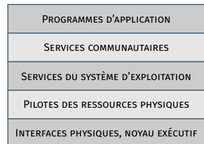
FIGURE 1.8 — Représentation statique du système d'exploitation : descriptif et approche en couches (cf. Interstices ).
