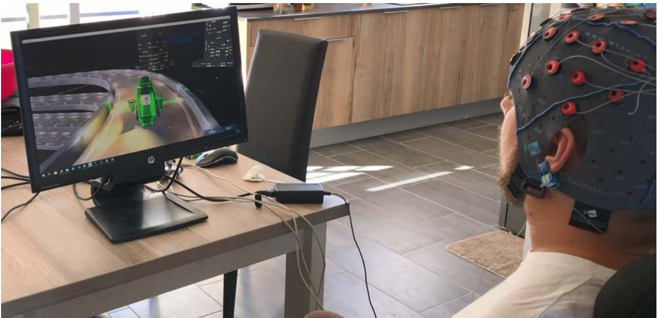
Figure 4 : Entraînement d'un utilisateur tétraplégique au contrôle par la BCI d'un jeu de course de voitures, en vue de sa participation au Cybathlon [7].
