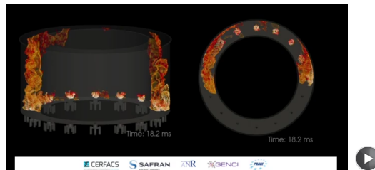
LES de l'allumage dans une chambre de combustion (code AVPB)
