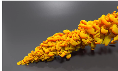
Jet en écoulement transverse (Iso-surfaces du critère Q)
