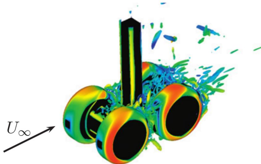
Simulation PANS de l'écoulement autour d'un train d'atterrissage rudimentaire
