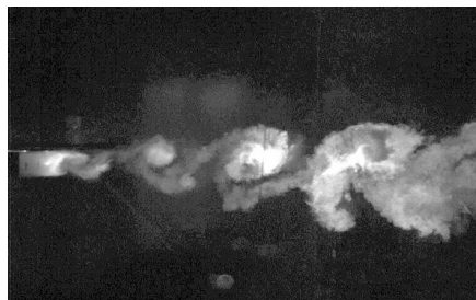
Couche de mélange derrière une plaque épaisse
