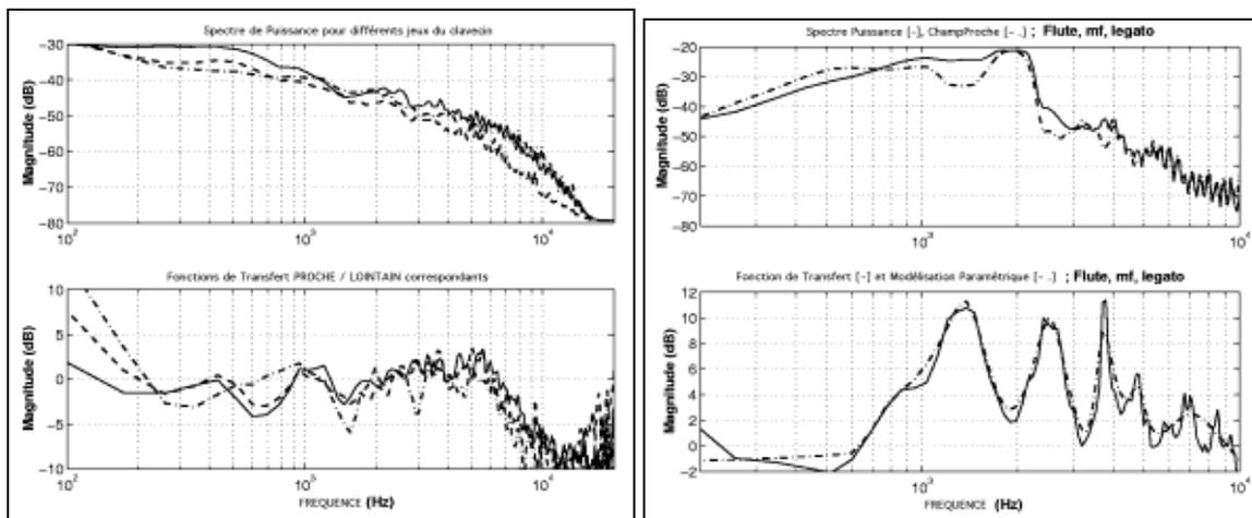
Figure 10a. Haut- spectre de puissance de différents jeux de clavecin ;
