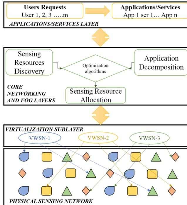
Fig. 1. Arquitectura IoT con hardware heterogéneo [4].
