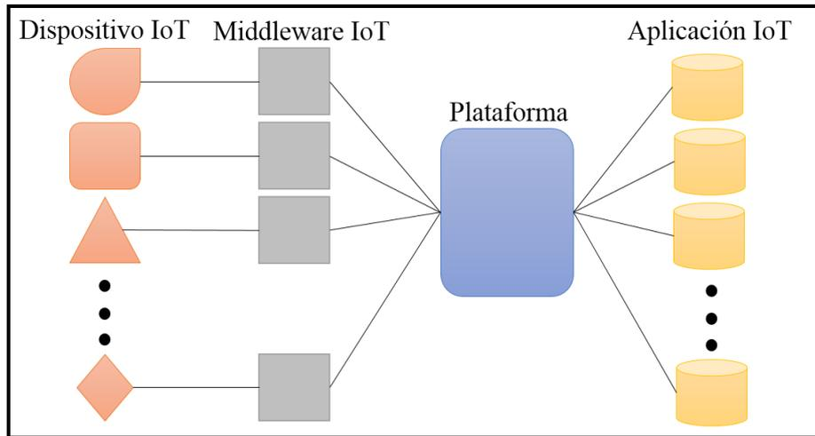
**Fig. 2.** Arquitectura de plataforma de servicios con hardware heterogéneo [10].
