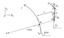
Fig. 8. Path tracking parameters
