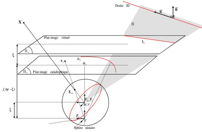
FIG. 1 – modèle unifié d'une caméra catadioptrique
