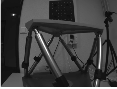
FIG. 1 – Observation de la plateforme de Gough par une caméra à courte focale.
