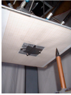
FIG. 12 – Plaquette et stylet permettant le tracé de la trajectoire.
