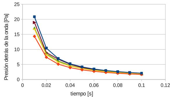
Figura 2: Presión detrás de la onda en función del tiempo. Malla regular. Azul: resultados teóricos. Rojo: 1er orden  $200 \times 200$ . Amarillo: 1er orden  $500 \times 500$ . Verde: minmod  $200 \times 200$ . Marrón: minmod  $500 \times 500$ .
