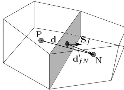
Figura 1: Discretización del dominio en volúmenes finitos ( $N$ : celda vecina;  $P$ : celda propietaria;  $\mathbf{d}$ : vector entre los centroides de las celdas propietaria y vecina;  $\mathbf{d}_{fN}$ : vector entre el centroide de la cara y el de la celda vecina;  $\mathbf{S}_f$ : Vector de superficie de la cara (vector normal a la cara cuya magnitud es el área de dicha cara)
