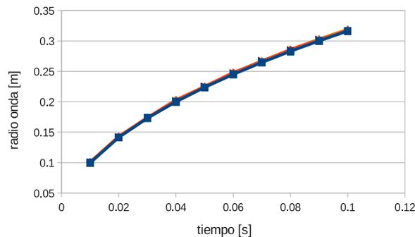
Figura 3: Posición de la onda de choque en función del tiempo. Malla regular. Azul: resultados teóricos. Rojo: 1er orden  $200 \times 200$ . Amarillo: 1er orden  $500 \times 500$ . Verde: minmod  $200 \times 200$ . Marrón: minmod  $500 \times 500$ .
