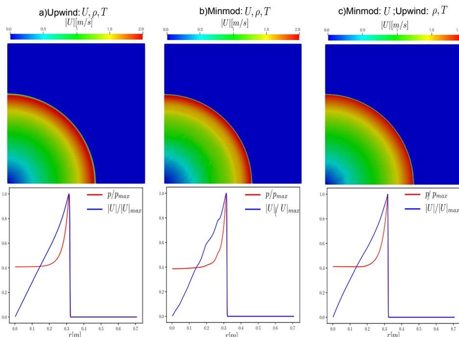
Figura 7: Simulaciones para  $t = 0, 1$  s. Superior: distribuciones de velocidad en todo el dominio obtenidas con cada combinación de funciones limitadoras empleadas en la reconstrucción; Inferior: distribuciones de presión y velocidad radiales.
