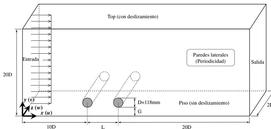
Figura 1: Diagrama esquemático del modelo de simulación.
