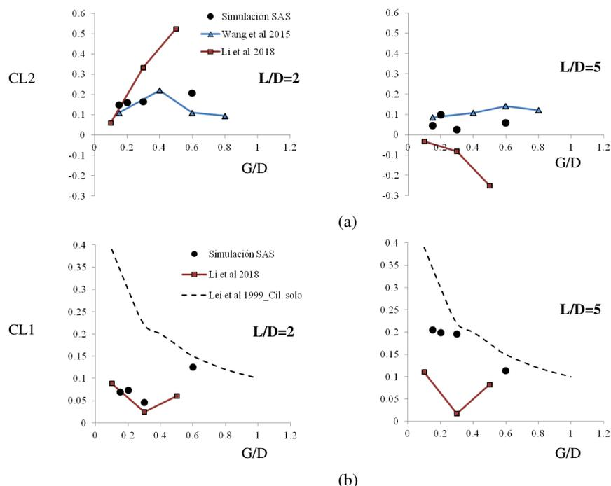
Figura 4: Coeficiente de sustentación para ambos cilindros en función de  $G/D$ ; (a) cilindro de atrás, (b) cilindro de adelante.
