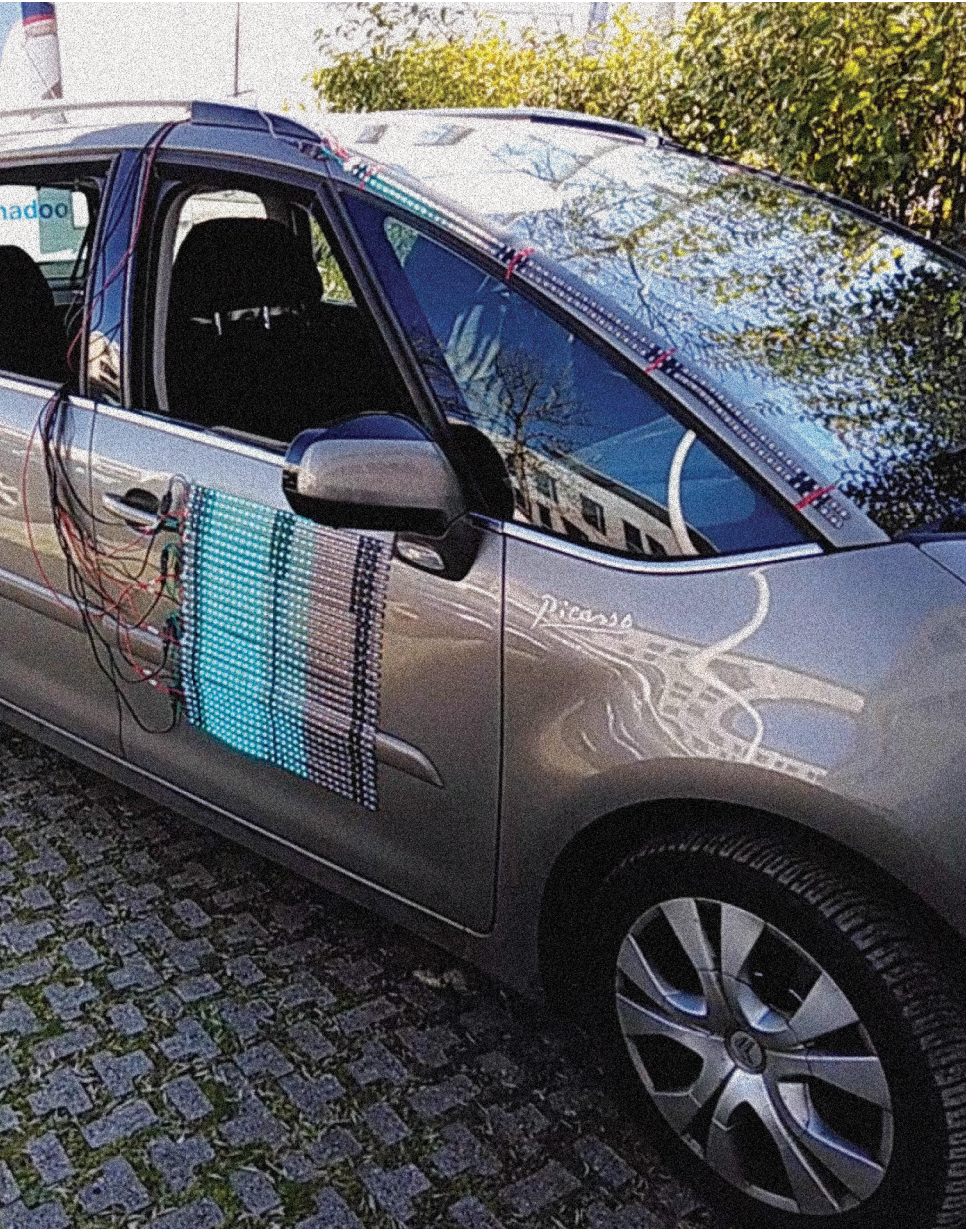
▲ Expérimentation 09 : à l'INRIA Animations précédentes intégrées sur le prototype d'un système d'affichage par Led testé sur un véhicule.
