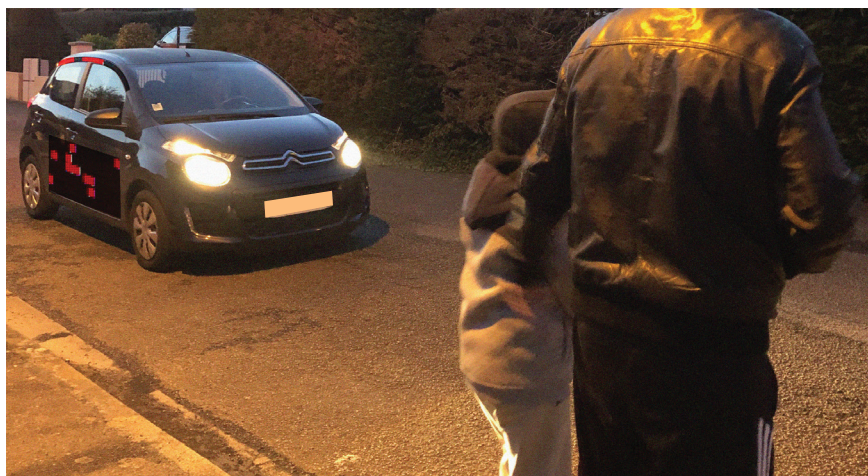
▲ Expérimentation 08 Séries d'animations pour indiquer l'arrêt et le redémarrage du VA. Ici, ce n'est qu'un test afin de mesurer la lecture et le comportement du piéton.
