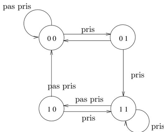
FIG. 2.4 – Automate de prédiction à deux bits
