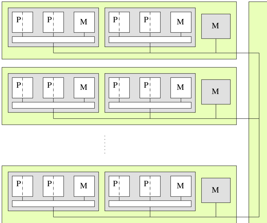
(a) Deux processeurs hyperthreadés et un peu de mémoire sur une même puce avec un niveau de cache, cette puce est implantée en deux exemplaires sur une même carte fille avec un peu de mémoire, et l'on enfiche enfin de telles cartes sur une carte mère.
