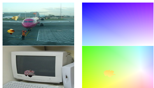
FIGURE 1 – Exemples tirés de la base de vidéos synthétiques. Les champs de vitesse associés sont représentés en code couleur, teinte pour la direction du vecteur, saturation pour son amplitude. L'image du haut est non saillante et celle du bas est saillante.
