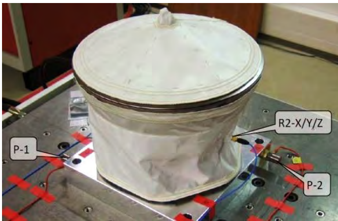
Fig. 19: Net: Vibration EVT Testing.
