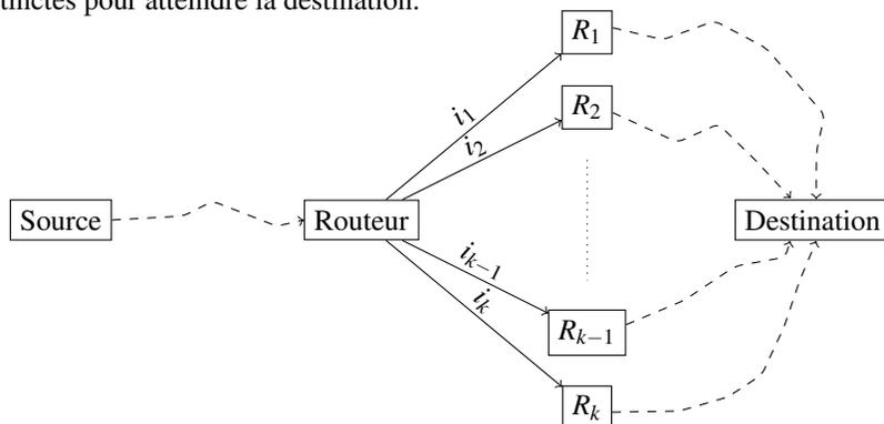
**FIGURE 1:** Un routeur à  $k$  interfaces de sortie.
