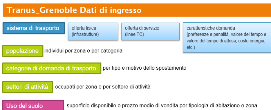
Figura 3: Rappresentazione schematica dei dati di ingresso necessari ad alimentare il modello di simulazione integrata di uso del suolo e dei trasporti Tranus_Grenoble .
