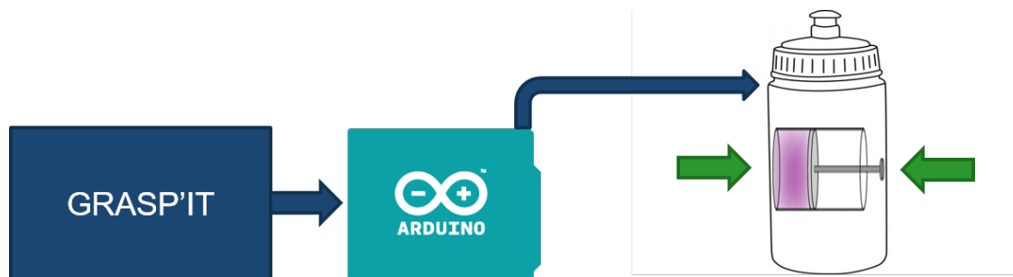
FIGURE 5.2 – Schéma illustrant le fonctionnement de la gourde avec un vérin pneumatique
