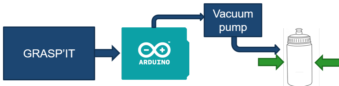
FIGURE 5.4 – Schéma illustrant le fonctionnement de la gourde avec une pompe à vide
