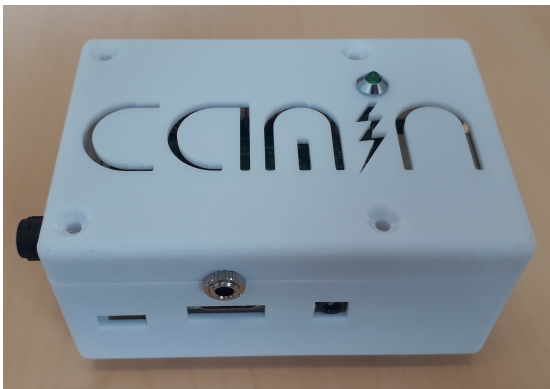
(a) Boîtier contrôleur contenant les têtes de réseaux et la carte Raspberry Pi.
