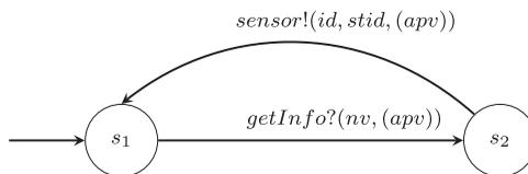
Figure 4. Sensor automaton.
