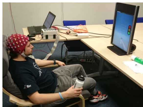
Figure 1 : Présentation générale du système Grasp'it : Le sujet génère des IMKs enregistrées via un casque EEG, le signal est analysé et traité, l'interface visuelle permet à l'utilisateur d'évaluer sa performance et l'invite à s'améliorer.
