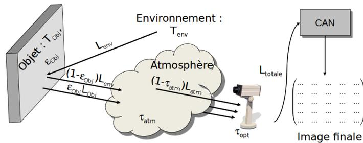
Figure 1: Illustration des différentes contributions radiatives reçues par la caméra infrarouge.
