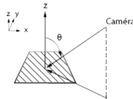
Figure 3: Angle entre l'objet et la caméra
