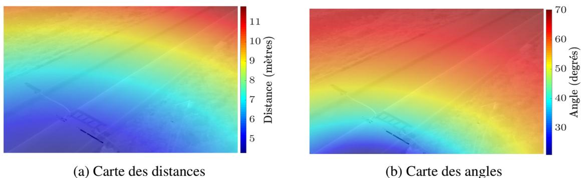
Figure 4: Valeurs issues de la calibration : distance et angle entre la caméra et l'objet observé.
