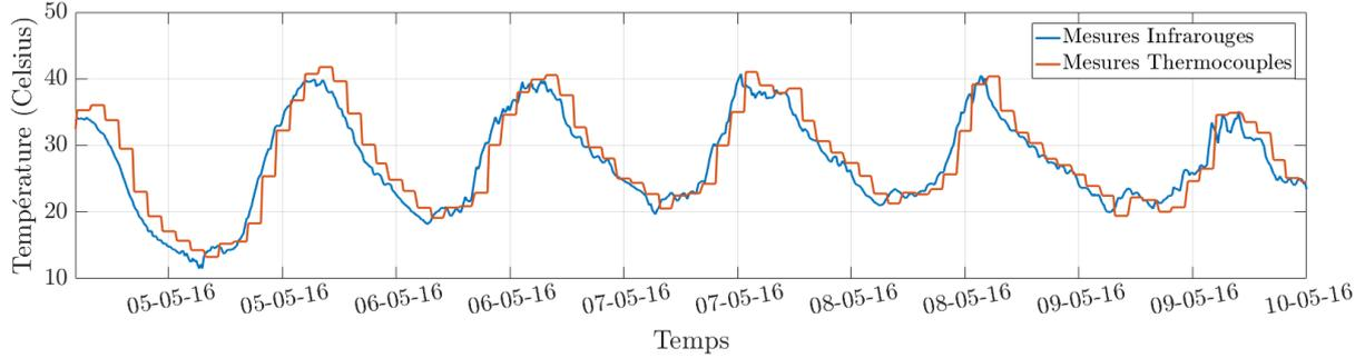
Figure 5: Mesures infrarouges comparées aux mesures thermocouples
