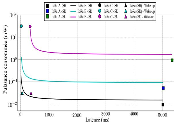
FIGURE 2. Consommation d'énergie en fonction de la latence.
