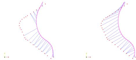
FIGURE 1 – Appariements (bleu) entre les points projetés du vaisseau 3D  $c$  (magenta) et les points du vaisseau 2D  $v$  (rouge), pour un cas donné. A gauche la méthode de Fréchet, à droite la méthode de Fréchet pondéré.
