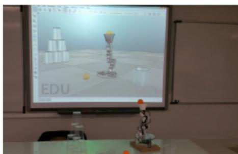
Un simulateur plus complet que le visualisateur existe, le logiciel open source Vrep, pour reproduire précisément des situations réelles avec prise en charge de l'inertie, des interactions physiques, etc...
